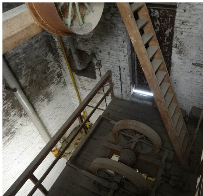
lier in de toren onder het waterreservoir
